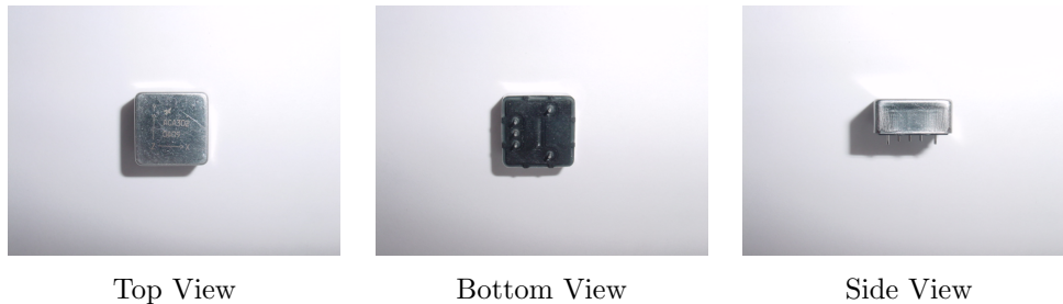
図 9.5: 3 軸加速度センサ (ASM302) (株) スター精密社製
