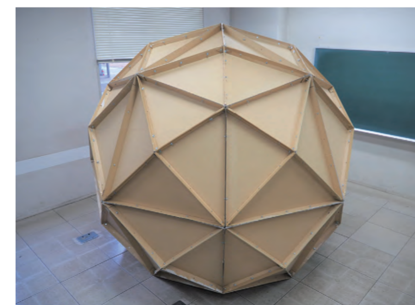
11, 南半球の上に、北半球をのせてドームが完成。完成すると、ドームの全体が安定し、強度がでる。ユニット (大) を 1 つずつ外し、出入口を設ける。
