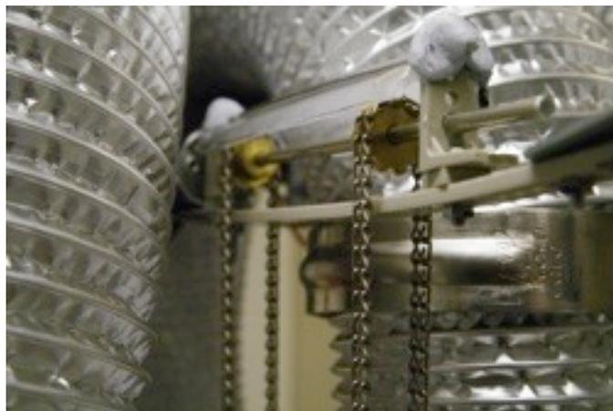
図52: ラダーチェーンとスプロケット機構の様子(モデル2)
