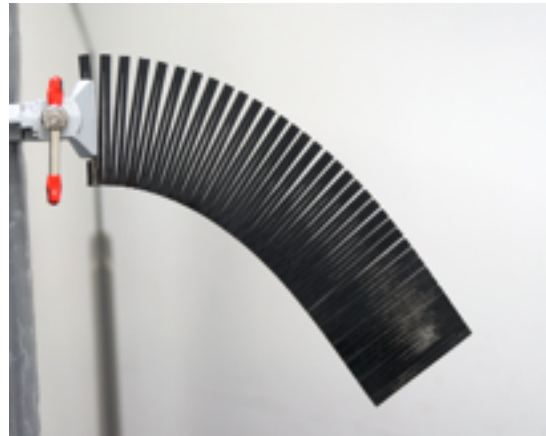
図16：15とは異なるパターンのパターン弾性体の変形
