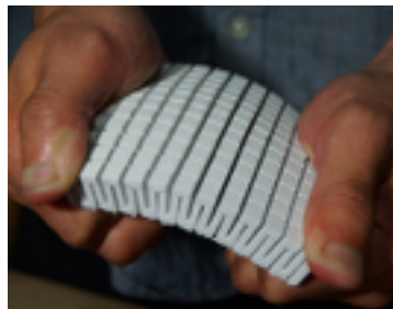
図2：三次元プリントされたパターン弾性体
