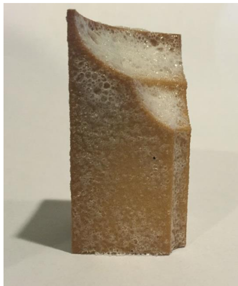
（図1 2）240℃の熱で20分熱した出力物
