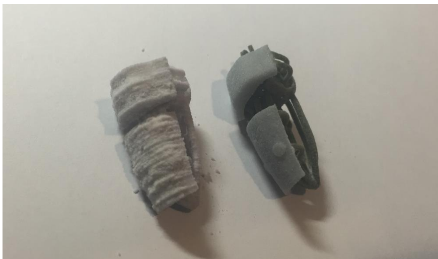
図6, wrl 形式での出力物 (左) と zpr 形式での出力物 (右)
