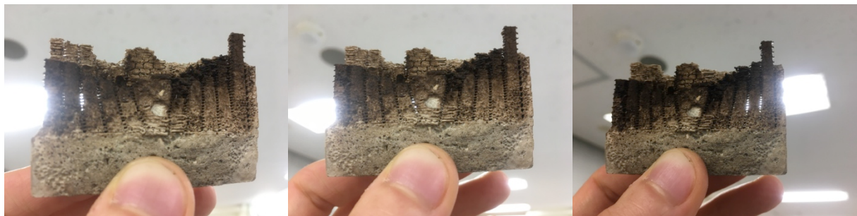
(b) コンクリートブロックを左、正面、右から光源に透過させて観察した様子。
