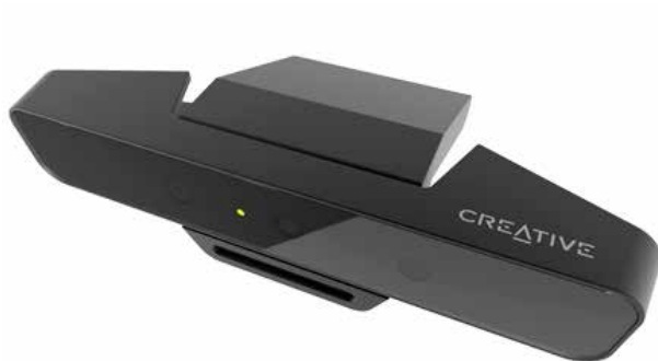
今回用いたrealsenseのsr300というタイプの近距離カメラ
