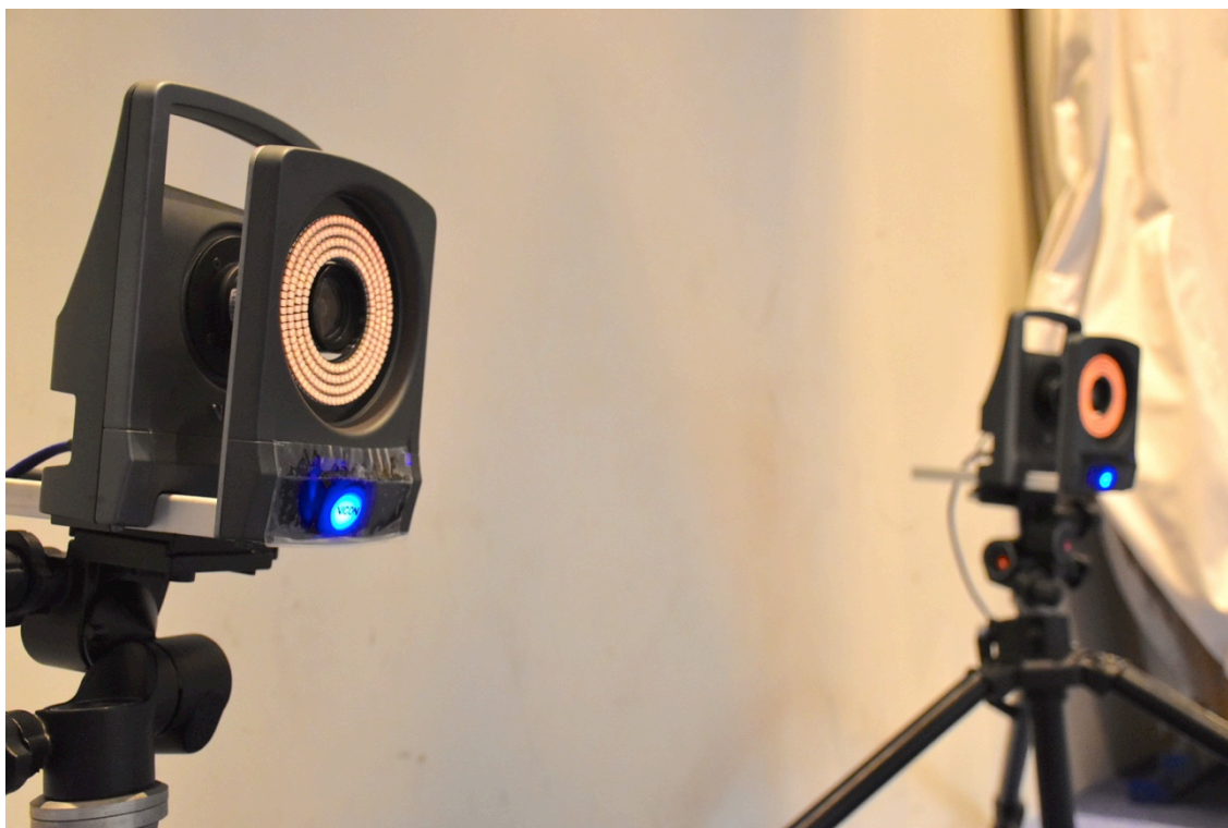
図 3.1 モーションキャプチャシステム (Vicon Mx T-20)
