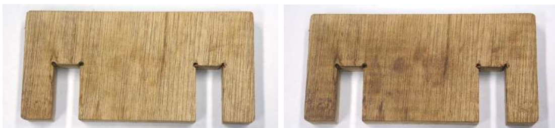
(図 39) 160 度で熱処理が加えられた木材 (左: 10 分、右: 30 分)
