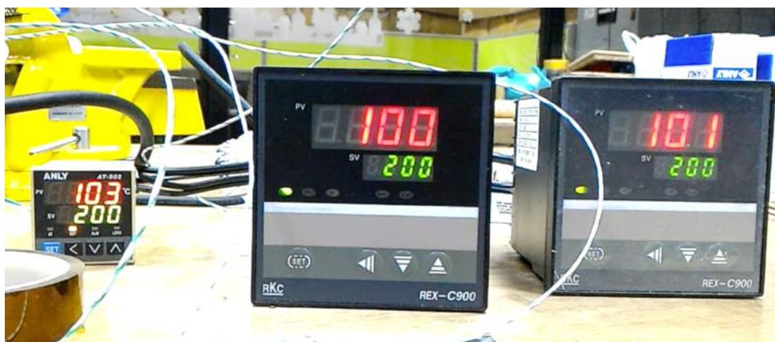
(図 35) 実験環境(左:ポリイミドヒーター越しに測定、中:鉄板を直接測定、右:カプトンテープ越しに測定)
