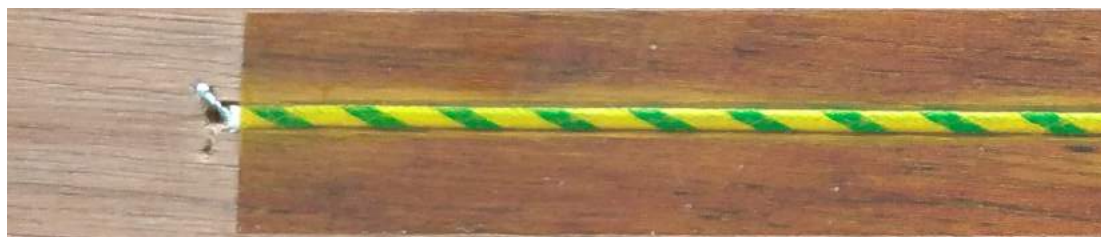
(図 32) センサ先端部がヒーターの熱線の上にまではみ出している状態で鉄板と合板が密着して圧力がかかってしまっている
