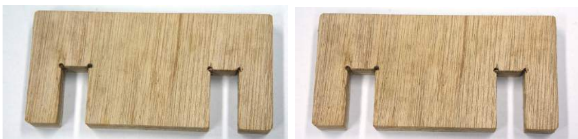
(図 38) 140 度で熱処理が加えられた木材(左:10 分、右:30 分)
