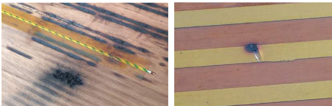
(図 18)アセンブリ時の粗雑な扱いで傷がついたことで発生したと思われるスパーク跡(左:板材側 右:ヒーター側)
