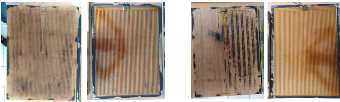
(図 6) Cogon 設置 3 号機のヒーターおよびヒーターに密着した板材 (上面:左、下面:右)
