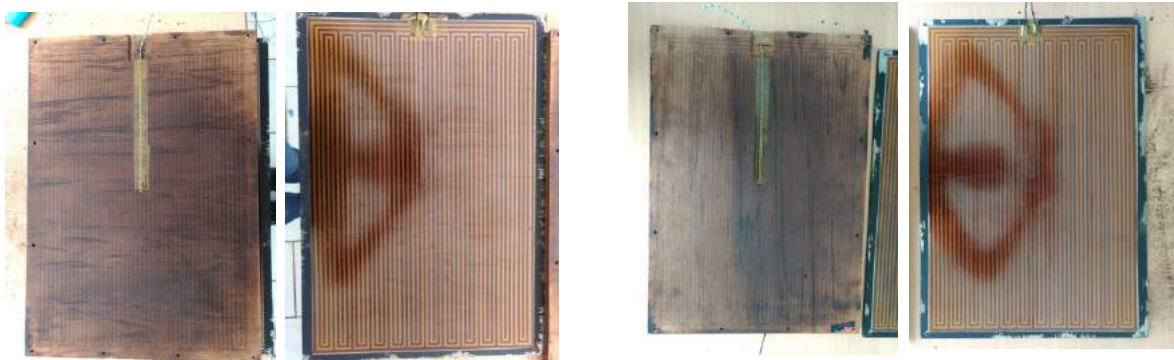
(図 4) Cogon 設置 1 号機のヒーターおよびヒーターに密着した板材 (上面:左、下面:右)
