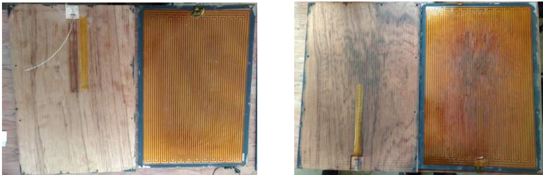
(図 9) Dampas 設置 1 号機のヒーターおよびヒーターに密着した板材(上面:左、下面:右)
