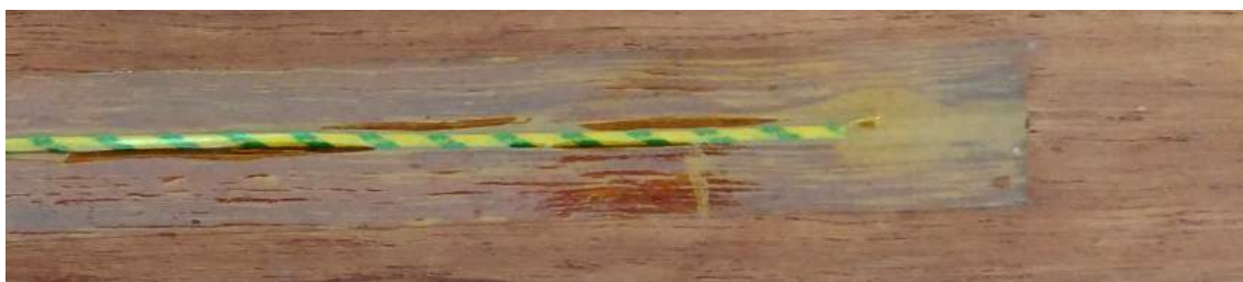
(図 34)熱電対温度センサがカプトンテープによって隠れてしまっており、 直接ヒーターないし鉄板に接していないアセンブリ
