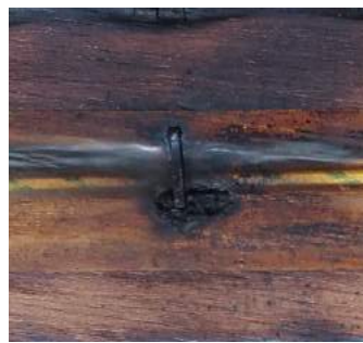
(図 16) 建築用ホチキスで傷ついて発生したスパークの跡 (左:ヒーター側、右:板材側)
