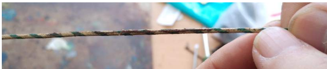
(図 31) 熱電対温度センサの全体にプレス圧がかかって扁平型となっている
