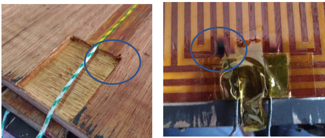
(図 19)組立時に発生したバリと、バリにより引き起こされたヒーターの焦げ
