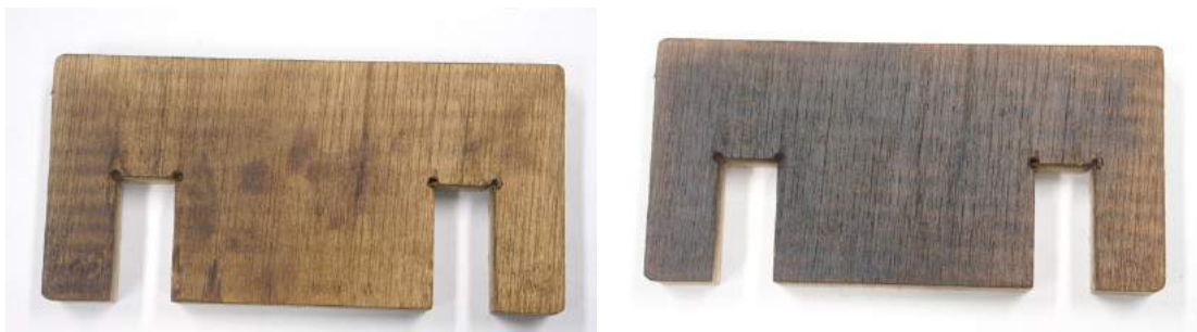
(図 40) 180 度で熱処理が加えられた木材 (左: 10 分、右: 30 分)
