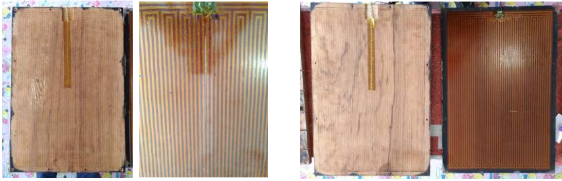
(図 7) Poblacion II 設置 1 号機のヒーターおよびヒーターに密着した板材(上面:左、下面:右)
