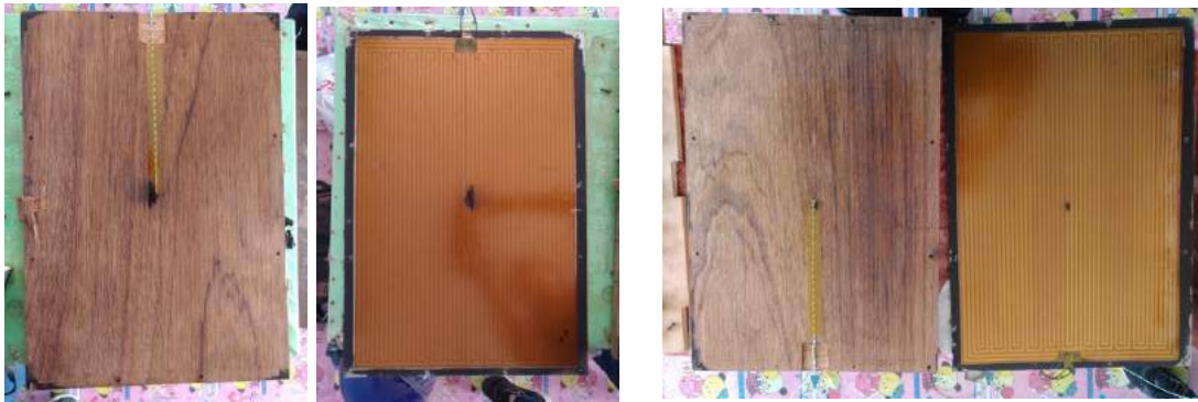
(図 8) Poblacion II 設置 2 号機のヒーターおよびヒーターに密着した板材(上面:左、下面:右)
