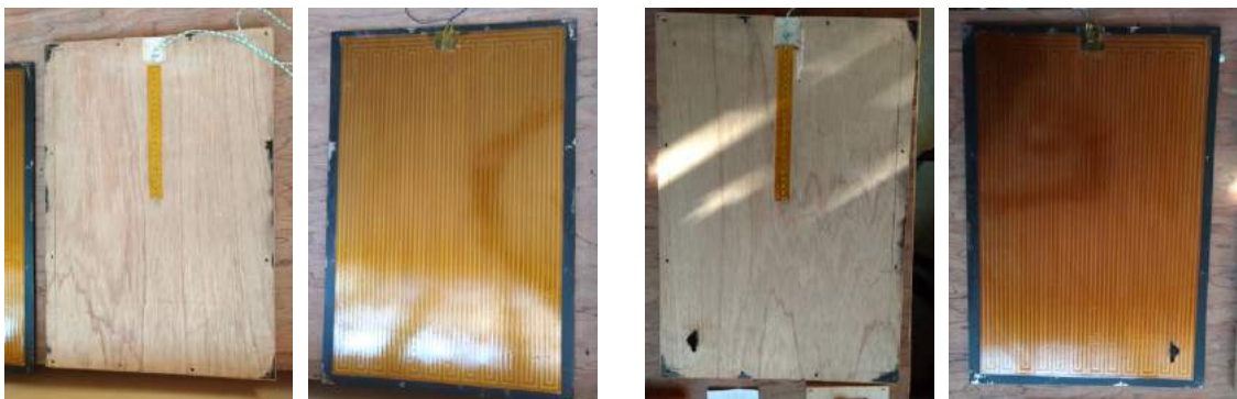
(図 10) Dampas 設置 2 号機のヒーターおよびヒーターに密着した板材(上面:左、下面:右)
