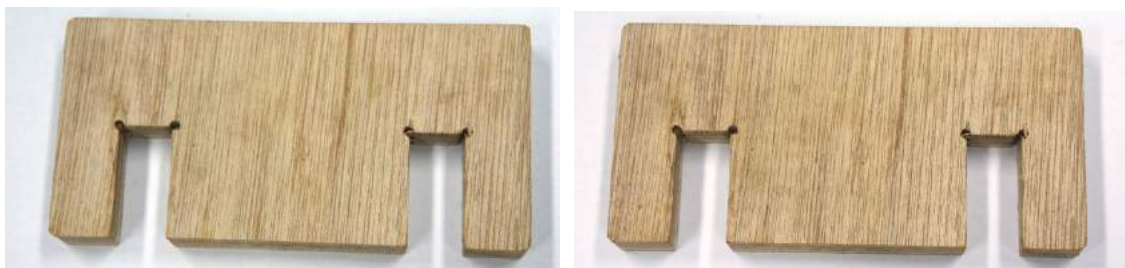
(図 38) 140 度で熱処理が加えられた木材 (左: 10 分、右: 30 分)
