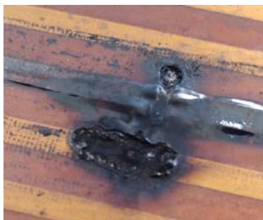
(図 16) 建築用ホチキスで傷ついて発生したスパークの跡 (左:ヒーター側、右:板材側)
