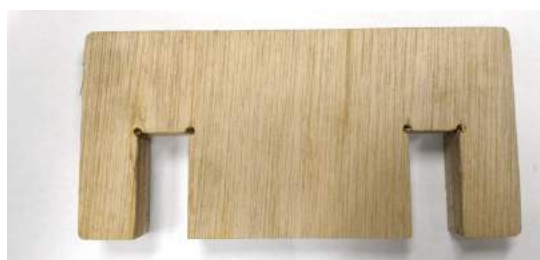
(図 37) 熱処理が加えられていないヒートプレスマシンに用いられたものと同種の木材
