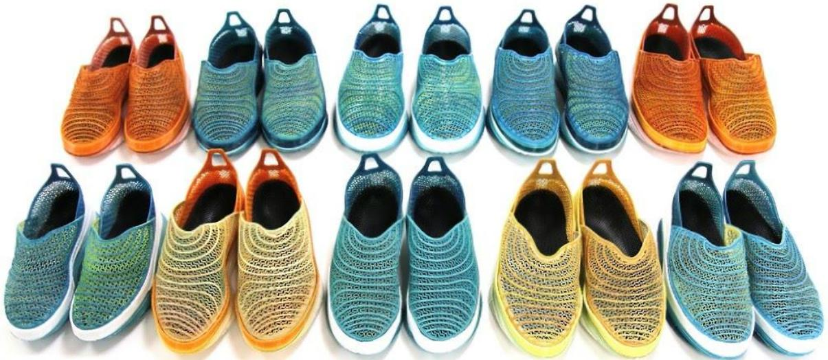
参加者の足の 3D スキャンデータとデザインへの個別要望を元に、歩容センサーを搭載可能な 3D プリントフットウェアをイベント期間内に制作して配布しました。このフットウェアは「しゃがんで紐を結ばなくてもすぐに履け、かつ長距離歩いても脱げないこと」や「がれきや危険な破片を踏む際にも、怪我無く安全に歩ける厚みがあること」を満たしており、災害発生時にもそのまま利用できる「フェイズフリー」のコンセプトに基づいて制作されています。データの取得をより日常的なものにするためのデバイスとして、さまざまなフィードバックを得ることができました。
