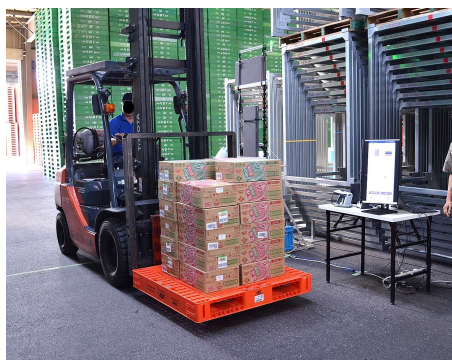
ゲートを通過する DXh タグ版スマートパレットと 情報がひもづけられた積み荷
