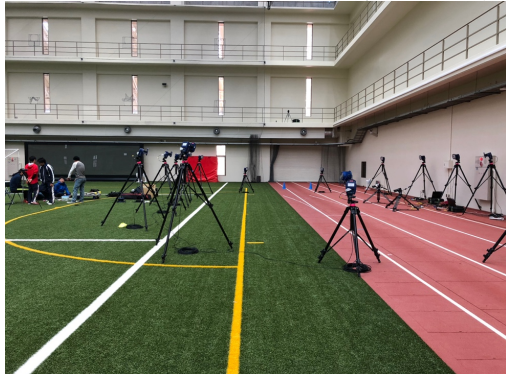
図3:スポーツパフォーマンス研究棟内屋内実験トラック (50mトラック全体にフォースプレートが埋設)
