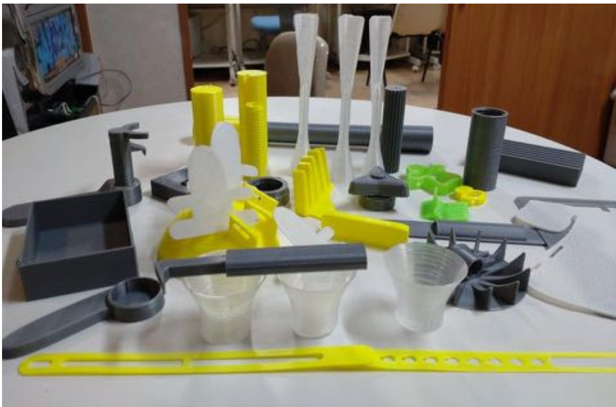
Fig.4 開発した3Dモデル配信出力システムを用いて協力施設(リハビリ病院)にて製作された自助具
