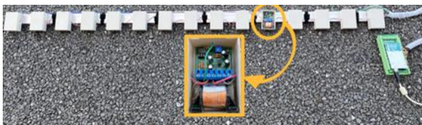
図8 電磁誘導線センサー
