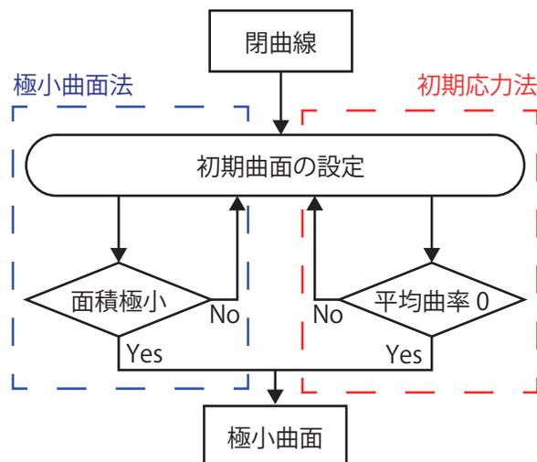
fig.2: 極小曲面の計算手法
