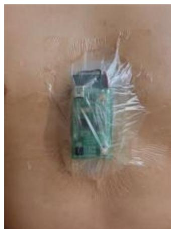
図 8. 胸部に取り付けた加速度センサ
