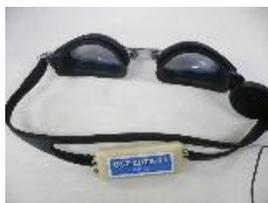
図 1. 加速度センサと位置計測センサを内蔵したゴーグル
